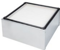
HEPA filtr AFR H14 PAP 850/650 minimální účinnost filtrace 99,995% dle EN-1822
