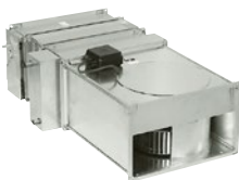
krátká sestava - klapka, filtr G4, 2ř. vodní ohřivač, celková délka sestavy je 1070mm
