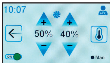
Nastavení hodnoty požadovaných otáček po kliknutí na ikonu ventilátoru
